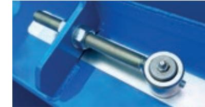
Pour effectuer le réglage de la tension du tapis, le positionnement du tendeur est placé à l'extérieur de la caisse. Cette opération est ainsi facile et rapide.
