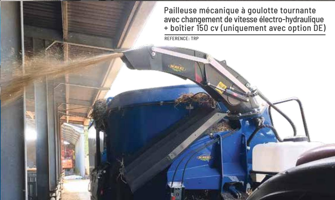
Pailleuse mécanique à goulotte tournante
