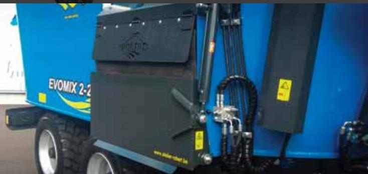
Pailleuse mécanique à goulotte latérale avec changement de vitesse à commande électro-hydraulique + boîtier 150 cv (uniquement avec option DE)
