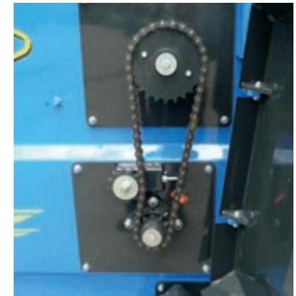
Transmission mécanique des démêleurs avec tendeur.
