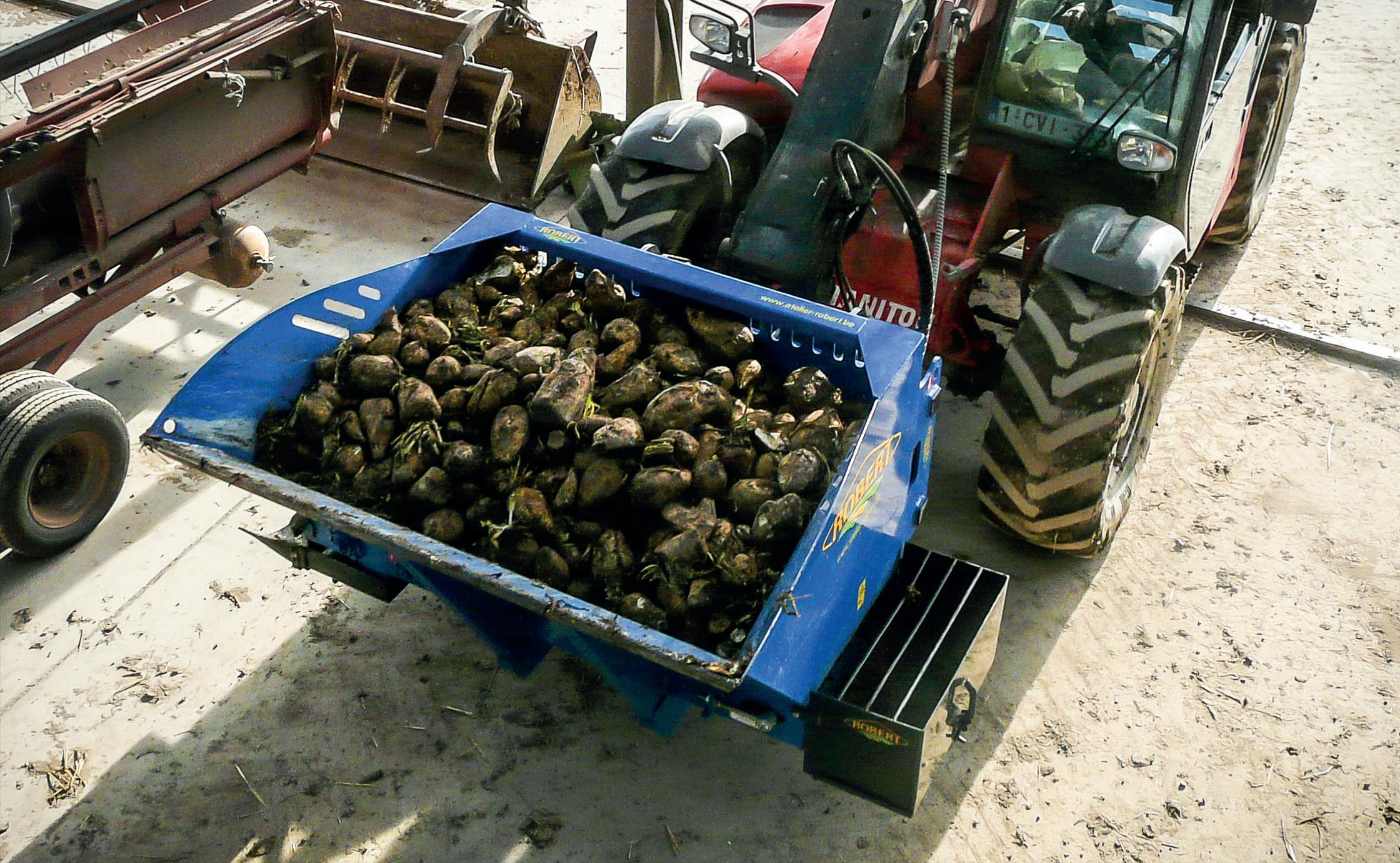
**DG** Distribution côté gauche en remplacement du côté droit pour modèle 3 points
