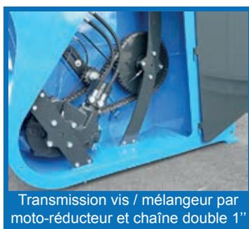
Transmission vis / mélangeur par moto-réducteur et chaîne double 1"
