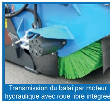
Transmission du balai par moteur hydraulique avec roue libre intégrée
