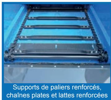
Supports de paliers renforcés, chaînes plates et lattes renforcées
