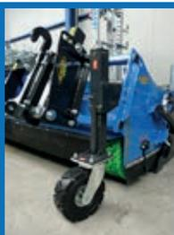
4 roues pivotantes diamètre 300 mm réglables en hauteur
