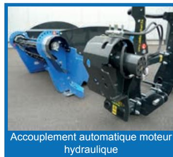
Accouplement automatique moteur hydraulique
