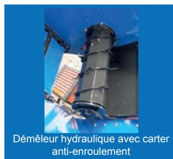
Démêleur hydraulique avec carter anti-enroulement
