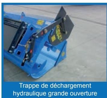
Trappe de déchargement hydraulique grande ouverture
