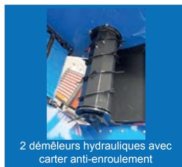
2 démêleurs hydrauliques avec carter anti-enroulement
